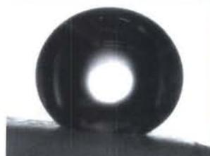
**Bild 2b: Wassertropfen auf strukturierter Teflonoberfläche**
