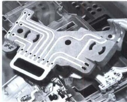
**Bild 3: Mit der chemischen Metallisierung wird eine 1 bis 3 µm dicke erste metallische Schicht auf das Kunststoffformteil aufgebaut.**
