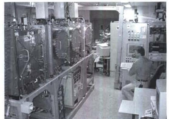
**An dieser Silizium-Beschichtungsanlage für bis zu 30 x 30 Quadratmeter große Glassubstrate fertigen Wissenschaftler des Instituts für Photovoltaik die „11,2-Prozent-Zelle“.**
