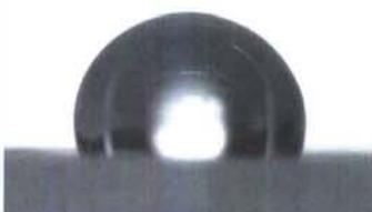
**Bild 2a: Wassertropfen auf unbehandelter Teflonoberfläche**
