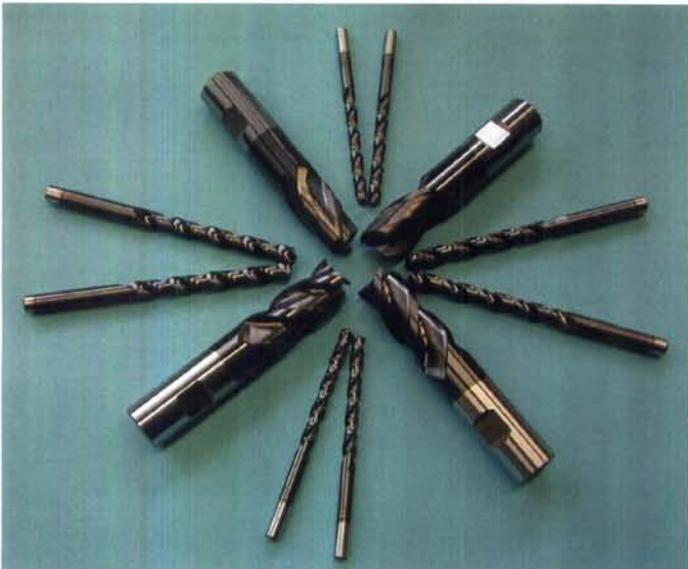
Zur Hochgeschwindigkeits-Bearbeitung von Al6061 werden Diamor-beschichtete Bohrer und Fräser ohne Einsatz von Kühl- oder Schmierstoffen eingesetzt. Bild: IWS
