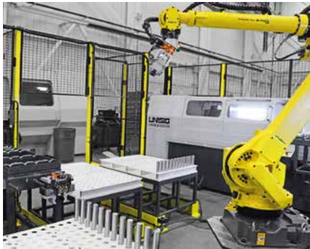
Inspektionsstation der 4-Spindel-Zelle.
