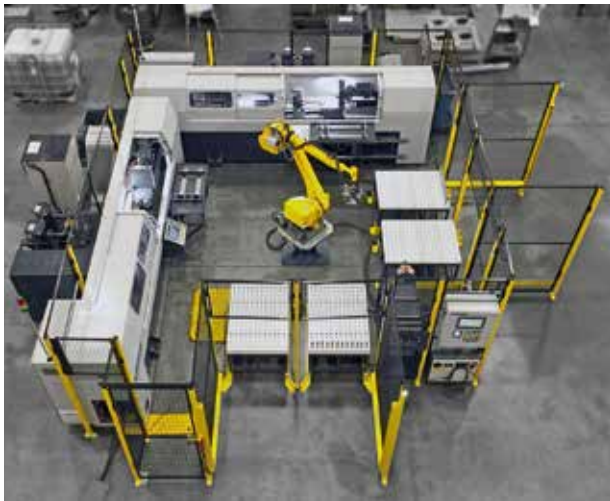
4-spindlige Tiefbohrzelle vmit flexibler Automatisierung.
