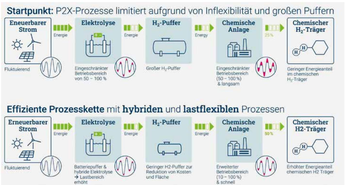
Die Grafik veranschaulicht den Unterschied zwischen einer Ammoniak-Synthese mit großem Pufferspeicher (oben) und einer Ammoniak-Synthese mit lastflexiblerem Reaktor (unten).
