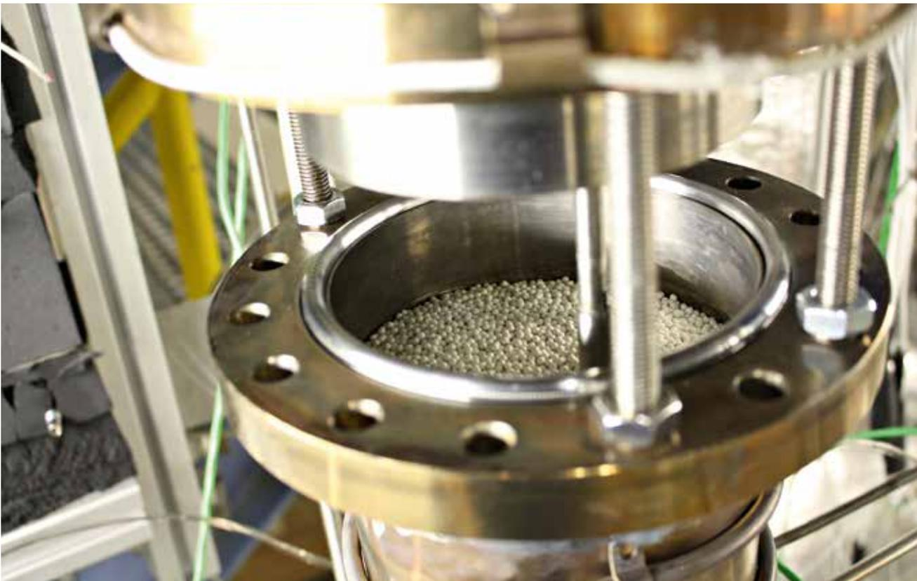
Prototyp im Labormaßstab: Die Keramikkügelchen speichern die Wärme.
