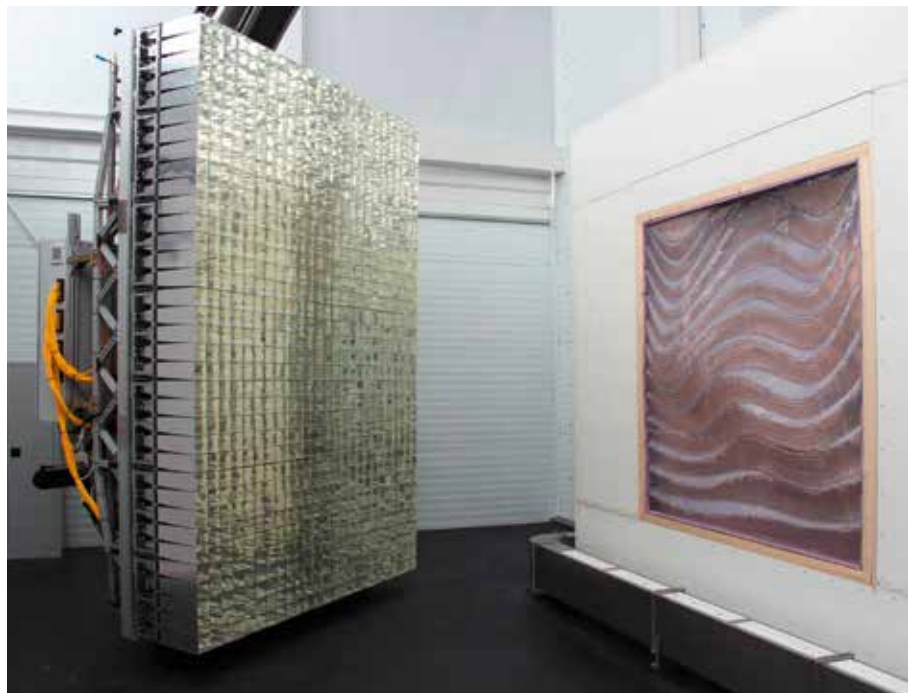
Eine halbtransparente Fassade aus gedrucktem Polymer ist bereit für den Test mit der künstlichen Sonne.
