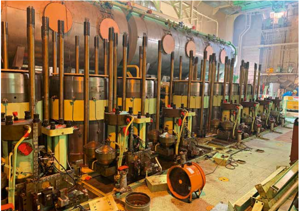
Sauber mit Methanol: Durch die Umrüstung des Hauptmotors zu einem Dual-Fuel-Motor kann das Containerschiff Maersk Halifax nun mit umweltschonenden Methanol betrieben werden.
