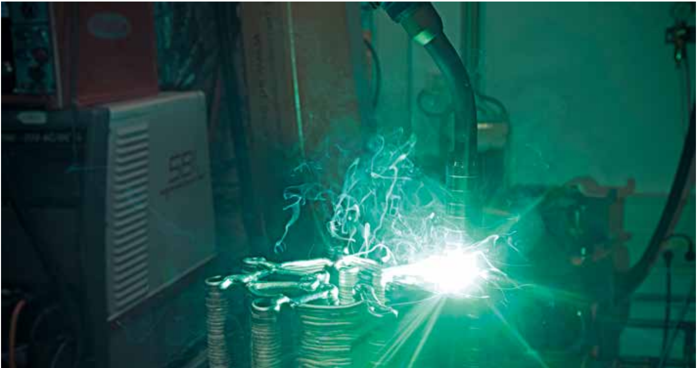
Geproba waDED-Prozess: Herstellung komplexer Geometrien, die mit konventionellen Verfahren wie Gießen oder Fräsen kaum zu realisieren sind.
